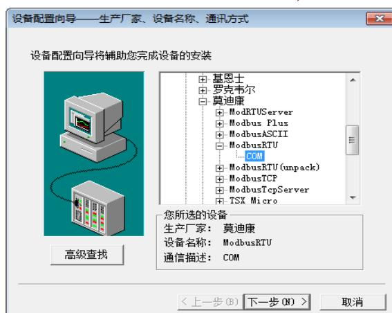
按照电磁流量计中的地址设置设备地址。下图以地址 1 为例：
