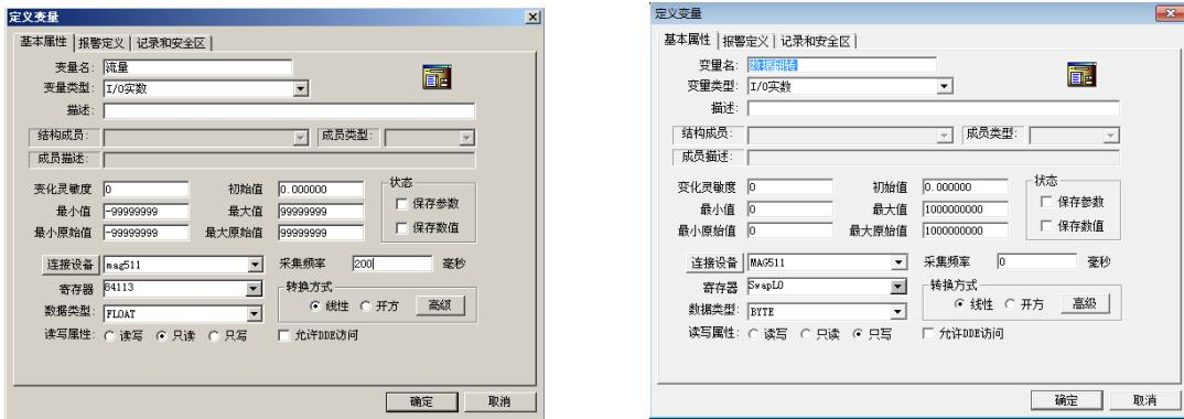
**注意：因电磁流量计数据存储格式的原因，在组态王添加变量时必须添加数据转换寄存器，否则通讯数据显示不正常。**
