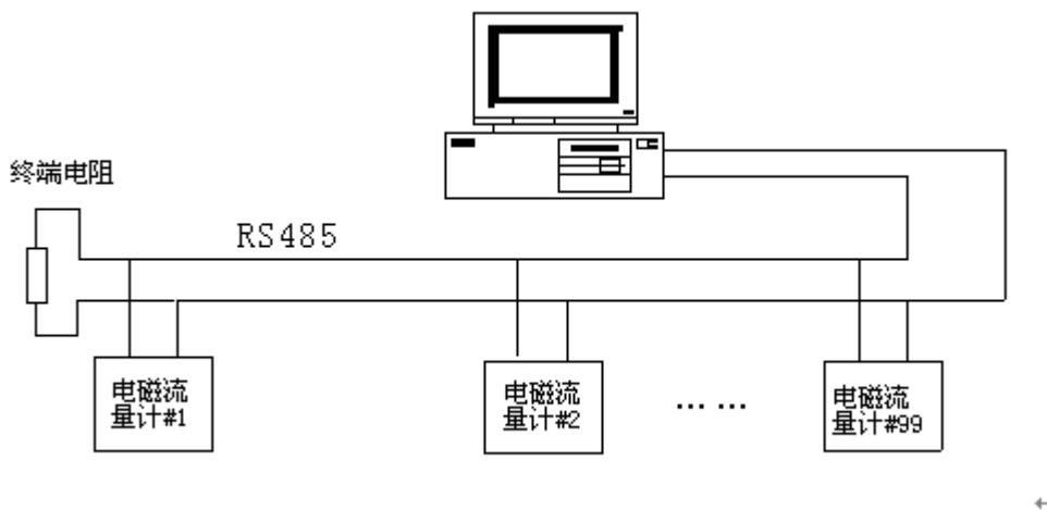
图-1 电磁流量计网络结构
