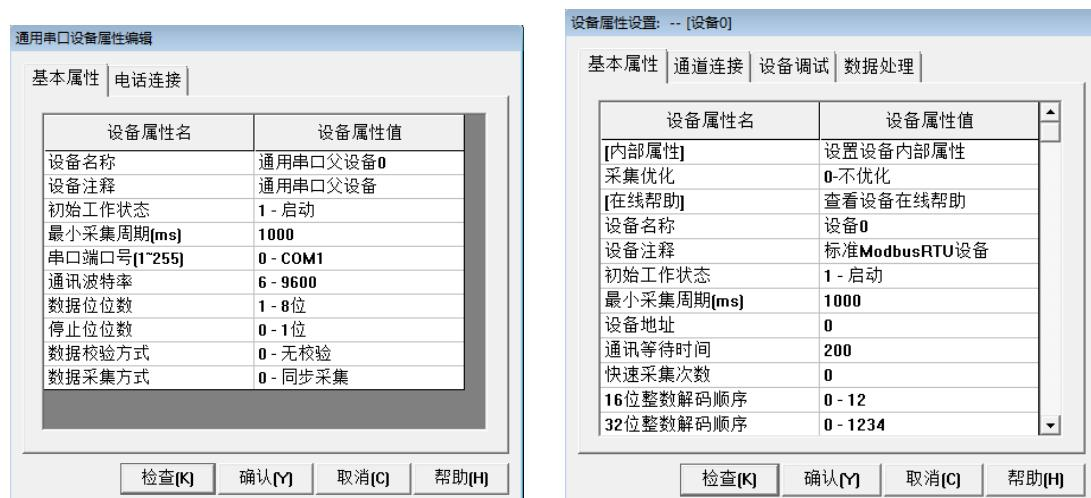
设备地址为 1,32 位浮点数解码顺序 0-1234, 校验方式 0-LH[低字节, 高字节]。选择设置内部属性。
