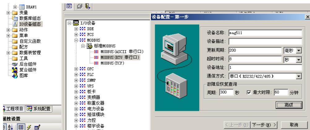
点击高级选项选择串口并设置串口参数（9600，8 为数据位、1 位停止位、无校验）
